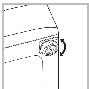
2. Dacă podeaua nu este perfect orizontală, compensați neregularitățile deșurubând sau înșurubând piciorușele anterioare (a se vedea figura); unghiul de înclinare, măsurat pe planul de lucru, nu trebuie să depășească 2°.
